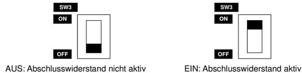
Abbildung 2-2 Schalterstellungen für Abschlusswiderstand
