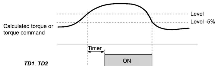
■ Low output torque detected--**U-TL**
