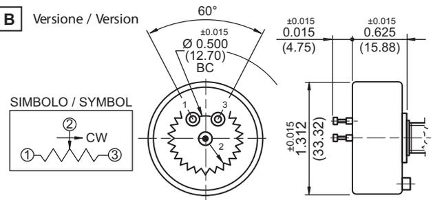
**Potenzometro rotativo - Spinning potentiometer**
